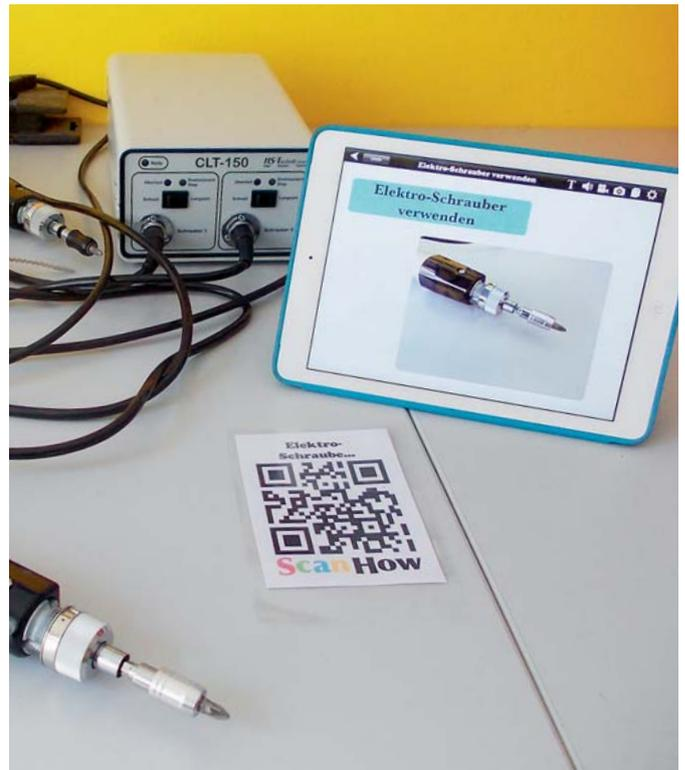
Die App ScanHow erklärt nach dem Scan des QR-Codes die Bedienung des Elektro-Schraubers auf dem Tablet.
