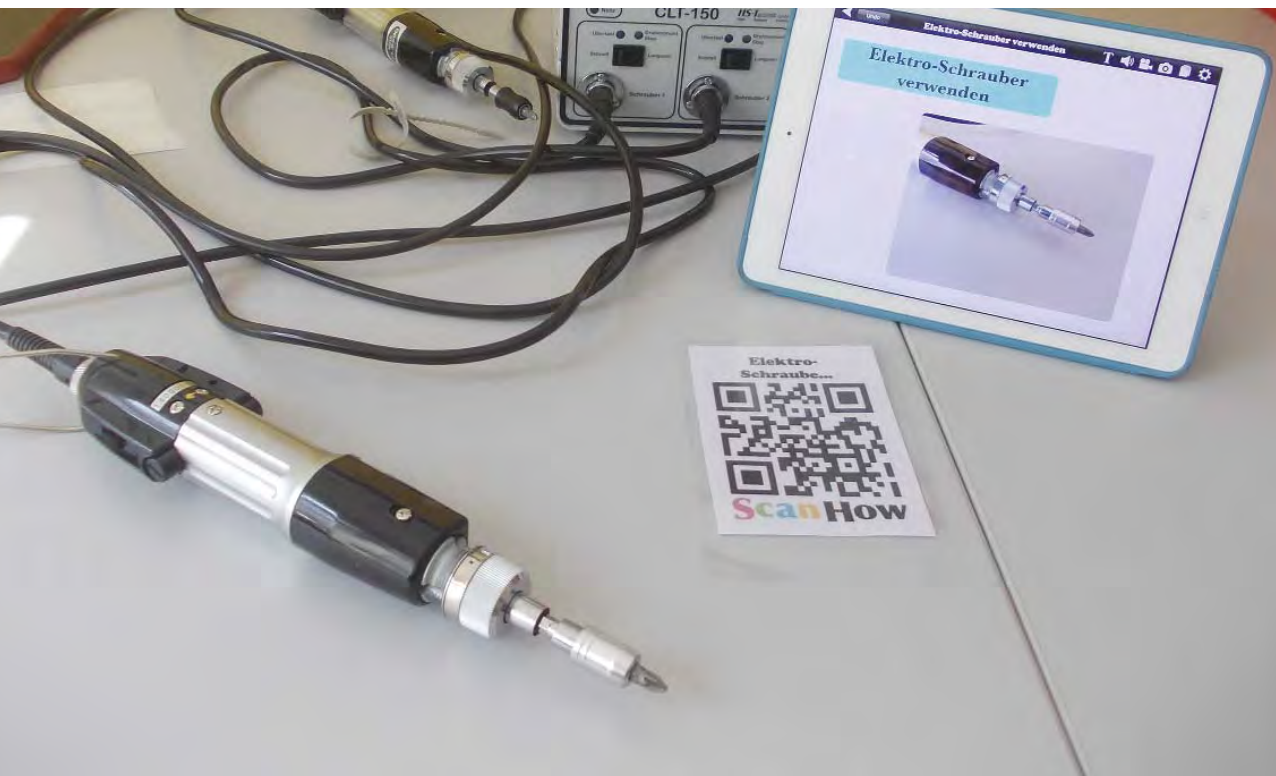
Arbeitsplatz mit Tablet-Unterstützung: Der QR-Code sorgt dafür, dass die passenden Erläuterungen ausgewählt werden.
